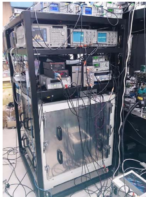
図 5.2 Minus-K を囲っている防音ボックスの様子
