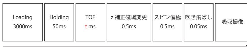
図 4.6: 残留磁場測定の実験シーケンス
