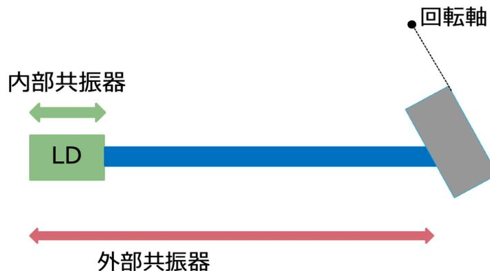
図 3.7 回転軸を決めて平面回折格子を回転させるとき.
